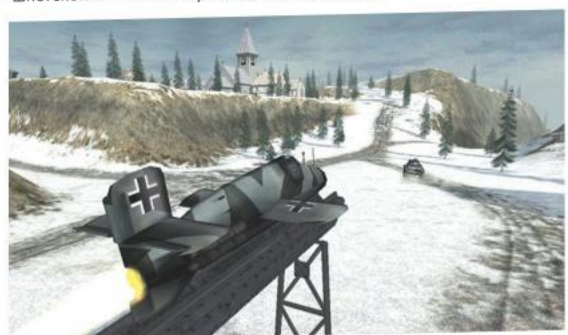
Главной задачей пилота «Наттера» было нацелить ракетоплан на бомбардировщик и выпустить ракеты. После этого пилот и фюзеляж спускались на отдельных парашютах. Единственный тест 1 марта 1945 года закончился гибелью пилота.
