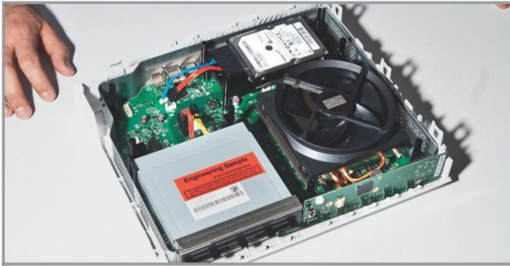
Большой кулер, множество решеток для забора воздуха — на этот раз Microsoft подошла к вопросу надежности очень серьезно.
