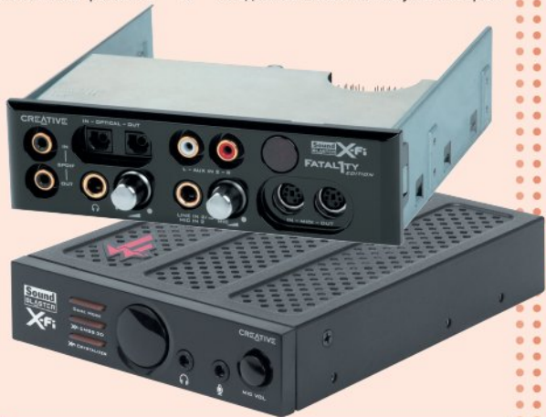
Внешняя панель новой Fatal1ty Edition сильно потеряла в функциональности, но зато стала помещаться в 3,5-дюймовый отсек.
