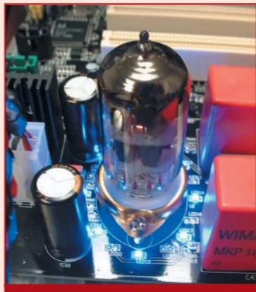
В свое время компания Aurep выпустила материнскую плату под Pentium 4, которая была оснащена ламповым усилителем звука.
