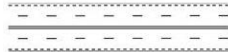
Marcaj de separare a sensurilor de circulație format dintr-o linie continuă dublă. Marcaj de delimitare a benzilor de circulație de același sens cu linie discontinuă. Marcaj de delimitare a părții carosabile cu linie discontinuă
