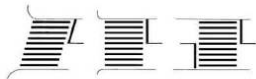
Marcaj de traversare pentru pietoni
