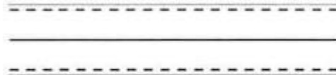
Marcaj de separare a sensurilor de circulație format dintr-o linie continuă simplă. Marcaj de delimitare a părții carosabile cu linie discontinuă
