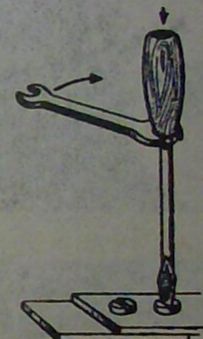
„recalcitrant”, care s-a înșepenit, picurăți în jurul capului său puțin ulei mineral sau petrol, lăsați o pauză de cîteva minute, după care fixați-i șurubelnița în creștătură și forțați lent mișcarea de rotație, cu ajutorul unei chei fixe, așa cum observați în figura alăturată.
