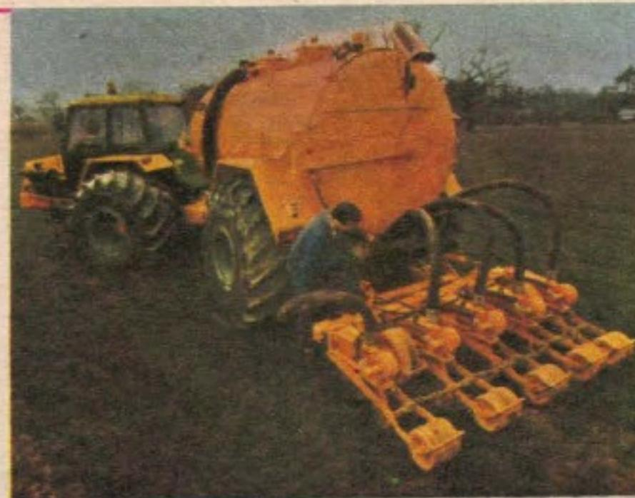
care injector este prevăzut cu un cuțit care dislocă solul și cu o rota metalică care aşază apoi braza la loc și acoperă, de asemenea, evenualele scurgeri de lichid. Sistemul de injectare este astfel atașat incit nu poate fi deteriorat în cazul cind în sol se află bolovani sau alte
