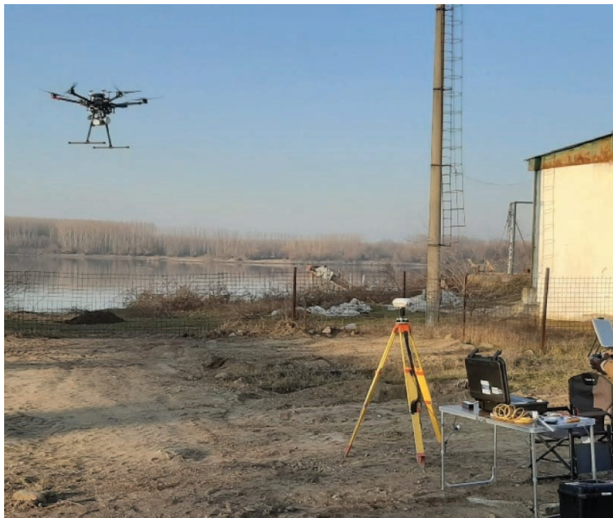
Fig. 1: Achiziția datelor LiDAR și optice
