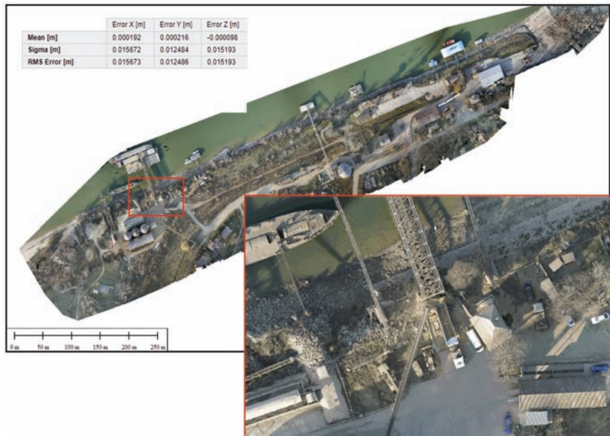
Fig. 2: Precizia și calitatea ortofotoplanului realizat (GSD 13 mm)
