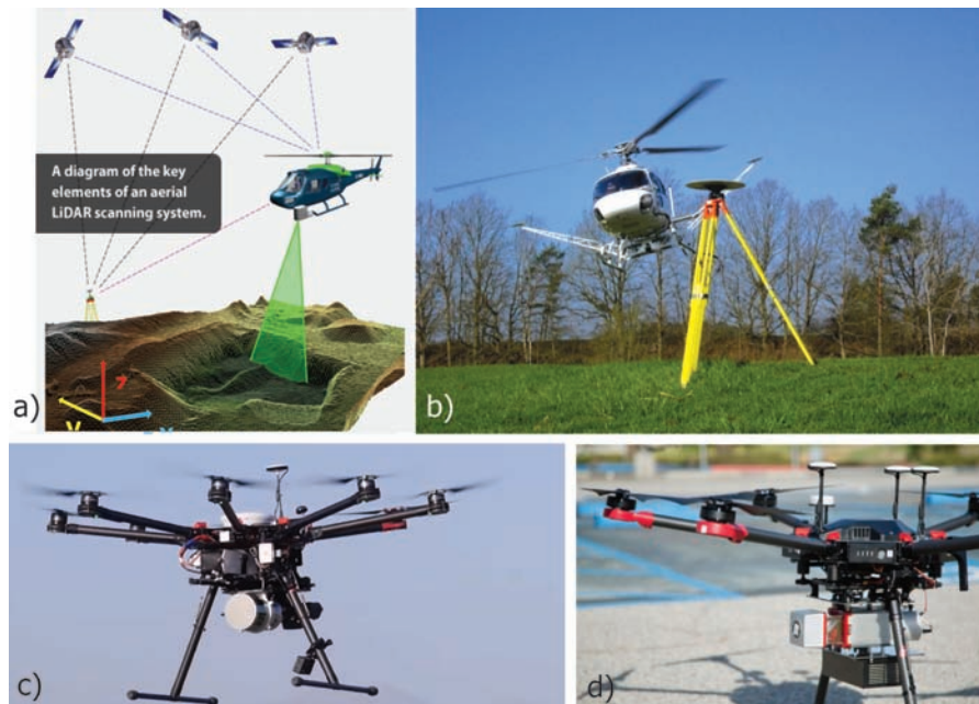
Fig. 1: a) Zbor fotogrammetric și LiDAR cu avionul, b) Zbor fotogrammetric și LiDAR cu elicopterul, c) - d) Zbor fotogrammetric și LiDAR cu drona
