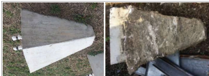
Fig. 5: Forma fundațiilor înainte și după încercare
