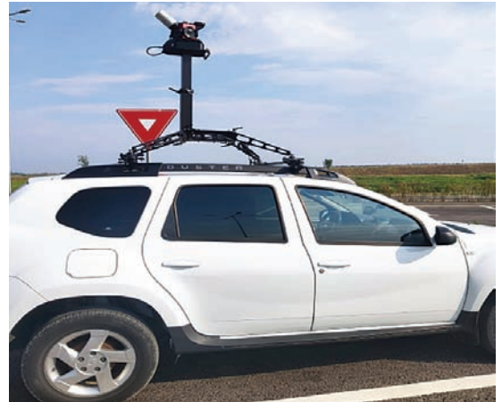
Fig. 1: Sistem de scanare mobilă Teledyne Optech Maverick
