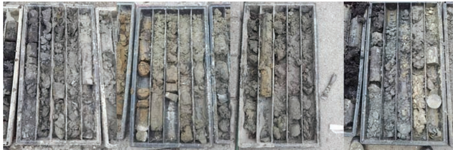
Fig. 2: Stratificația terenului între cotele -6,00 m și -10,00 m în forajele executate
