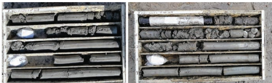
Fig. 3: Stratificația terenului între cotele -5,00 m și -10,00 m în forajele executate [5]
