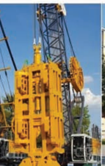
Foraje cu amestecarea solului forat - Cutter Soil Mixing - CSM
