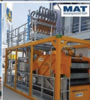
Instalații de preparare și injecție fluide de foraj
