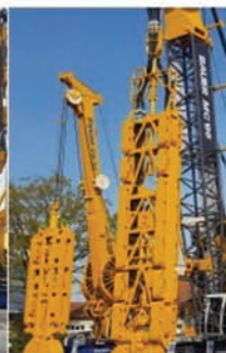
Foraje pentru pereți diafragmă cu unități de frezare și de graifere
