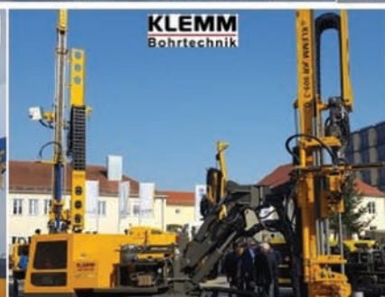
Foraje micropiloți, de ancorare, "jet grouting" și geotermale
