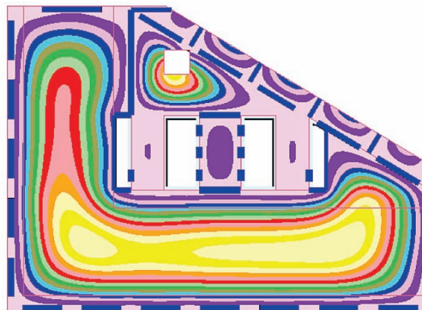
Fig. 10: Deformația planșeului din combinație de lungă durată (ține cont de curgerea lentă a betonului)
