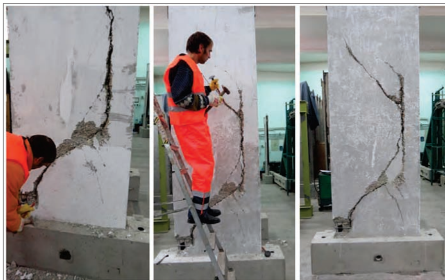
Fig. 9: Prelucrarea mecanică a speci­menelor
