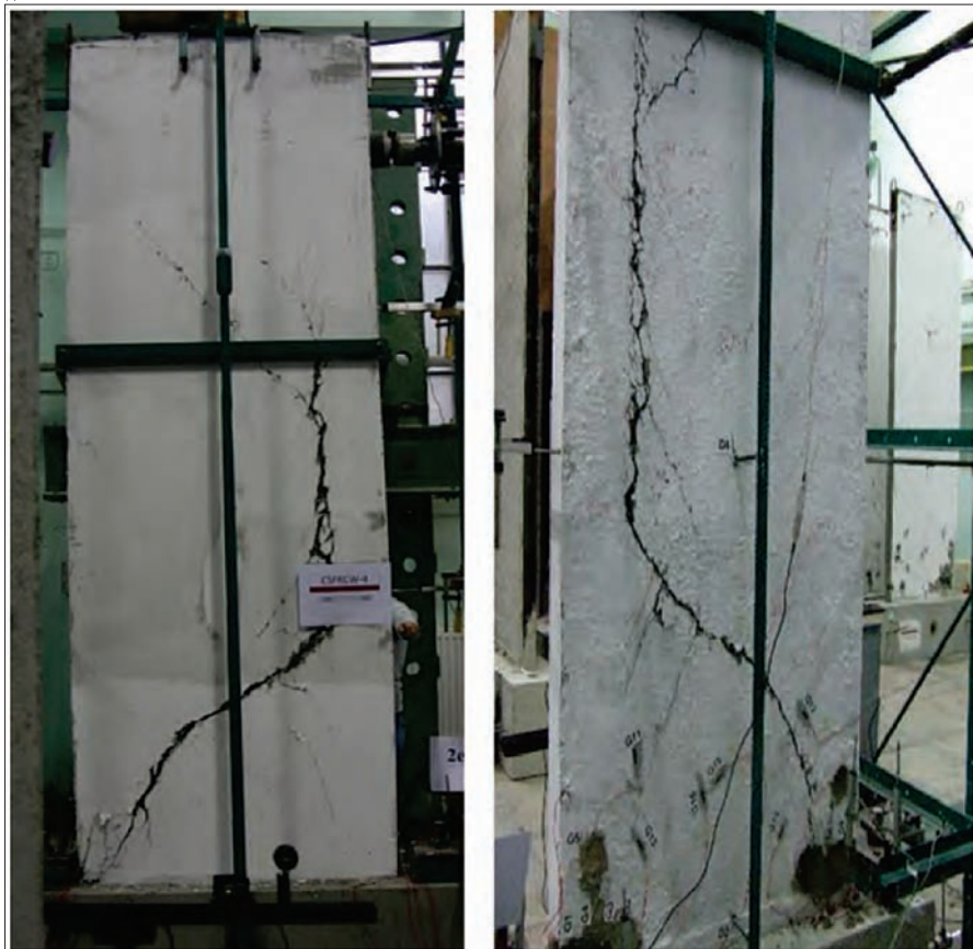
Fig. 8: Dezvoltarea fisurilor și crăpăturilor speci­menelor CSFRCW sub efectul încărcării la atingerea pragului de cedare al acestora
