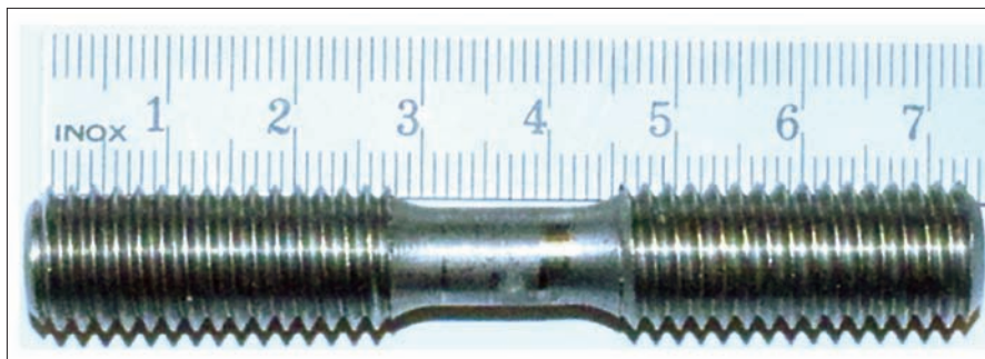
Fig. 2: Epruvetă prelucrată înainte de încercare
