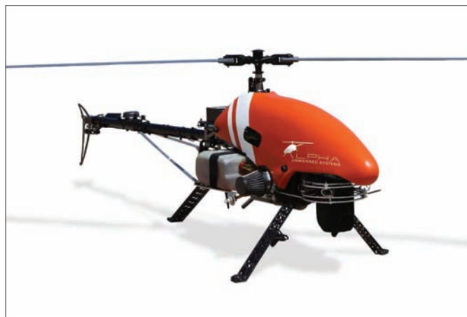
Fig. 2: Dronă de tip elicopter
