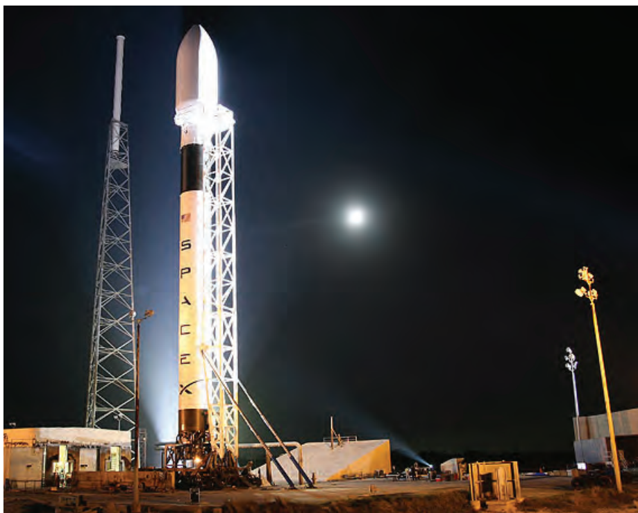
Falcon 9, cu carenaj de 5,2m (SpaceX)
