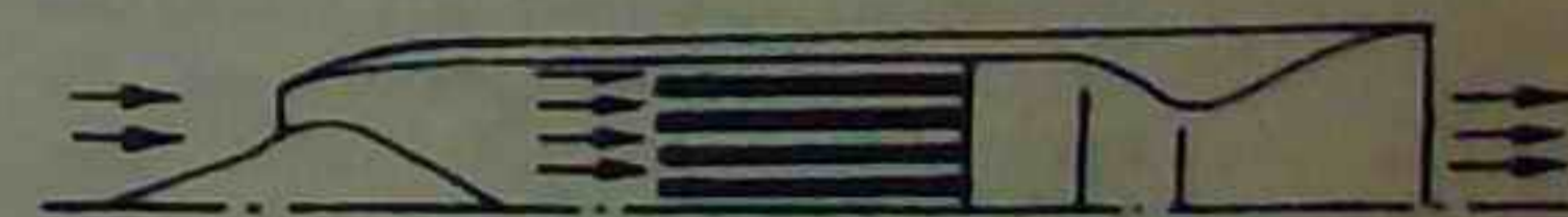
Fig. 4 — Schița motorului statoreactor cu utilizarea energiei atomice
