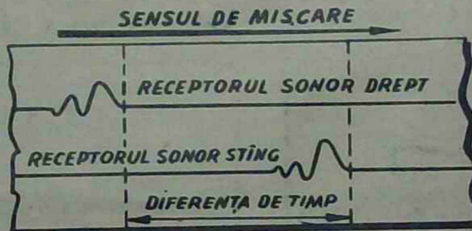
O bandă ce are înscrisă pe ea semnele captate de două receptoare sonore; sursa sonoră se află mai aproape de receptorul din stînga
