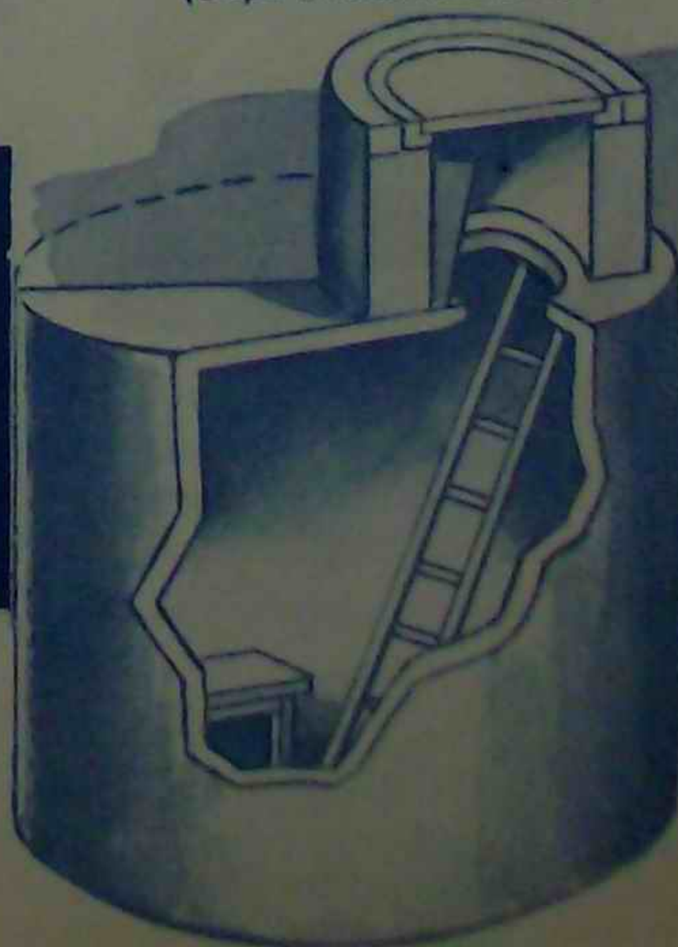
Fig. 4. Adăpost cilindric din fier-beton
