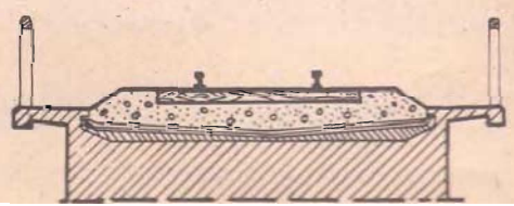
Fig. 12 DETALIU DE EXECUȚIE A CULEII
