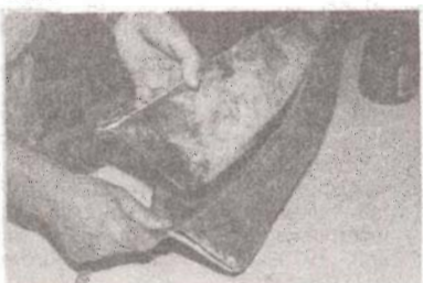
11, 12. — Pentru obținerea cocil se dă un strat de gelcoat. Apoi se dă un strat de poliester și se așază țesătura din fibră de sticlă.
