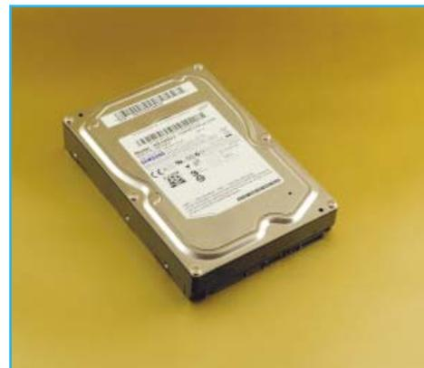
Serie: Spinpoint F1 RAID · Capacitate: 1TB · Interfață: SATA II · Viteză de rotație platane: 7200RPM · Buffer: 32MB · Număr platane: 3
