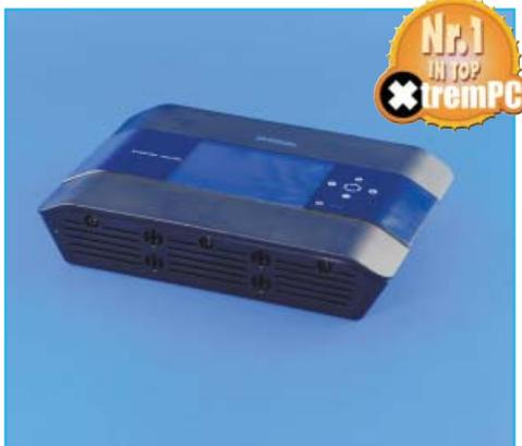
Protocoloale: Ethernet, 802.11b/g/n · Facilități: Network server, widget-uri Web, QoS, Hotspot · Conectori: 1WAN, 4LAN, USB, 2.5" HDD
