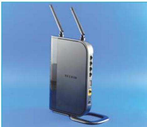
Protocoale: Ethernet, 802.11b/g/n · Facilități: Port Forwarding, Triggering, DNS dinamic · Conectori: 1WAN, 4LAN, USB
