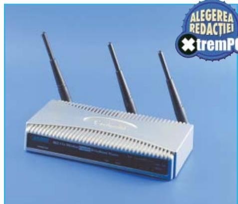
Protocoloale: Ethernet, 802.11b/g/n · Facilități: Port forwarding, DNS dinamic, Management de bandă · Conectori: 1WAN, 4LAN
