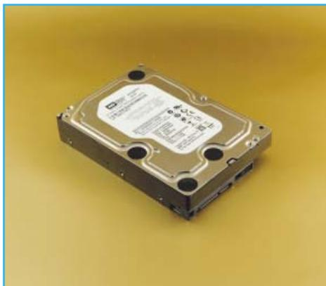
Serie: WD RE3 Enterprise SATA · Capacitate: 1TB · Interfață: SATA II · Viteză de rotație platane: 7200RPM · Buffer: 32MB · Număr platane: 3
