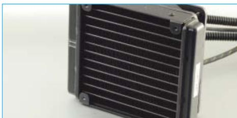
Corsair Hydro Series H50 este un sistem de răcire cu apă, destinat răcirii procesoarelor cu socket LGA 1366/775 și AM2/AM3.
