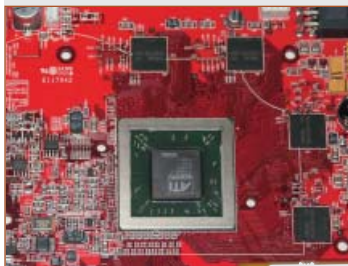
➔ GPU-ul are totuși o mică protecție împotriva ciobirii sale, banda din metal.
