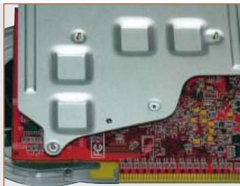
➔ Urmează prinderea cu șuruburi, nu folosiți prea multă forță!
