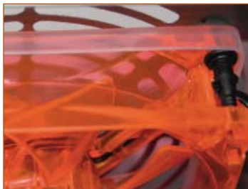
➔ Se observă sistemul de prindere și garnitura, ambele din cauciuc.
