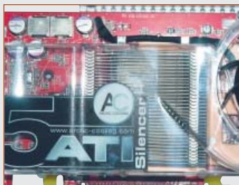
➔ La final trebuie montat conectorul de alimentare al ventilatorului.
