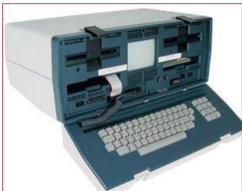
➔ Osbourne 1, primul computer cu adevărat portabil. A fost lansat în 1981.
