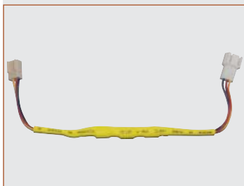
➔ Cablul necesar reducerii tensiunii de alimentare de la 12V la 9V.
