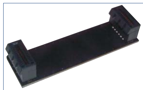
➔ Conectorul prin care comunică între ele cele două plăci video în mod SLI
