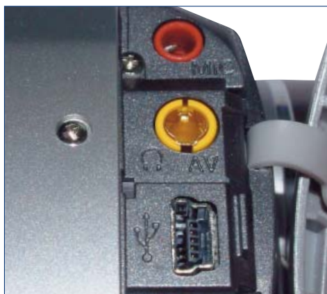
➔ Conectorul audio-video, mufa de microfon și portul USB 2.0 ale camerei video Canon MVX250i
