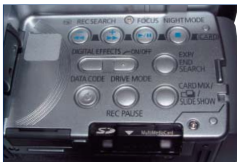
➔ Butoanele de control pentru funcția de vizualizare ale camerei video Canon MVX250i
