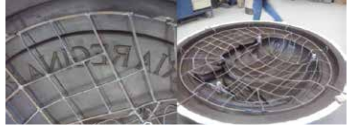
Fig. 13 Efigiile Regale Etapa V/2015, imagini înainte de turnare. Cele două efigii din bronz demontate de pe arc, realizându-se matrite pentru turnarea în simipiatră de sculptor – restaurator Alexandru Siminic. (Credo Design, 2015)
