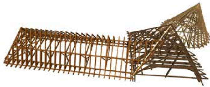
Fig. 6 Modelarea 3D în Archicad a ansamblului șarpantelor aferente clădirii principale executate în anii 2009-2011 - colțul nord-vestic, aripa vestică și turnul nord-vestic (echipa Irod M, 2009)
