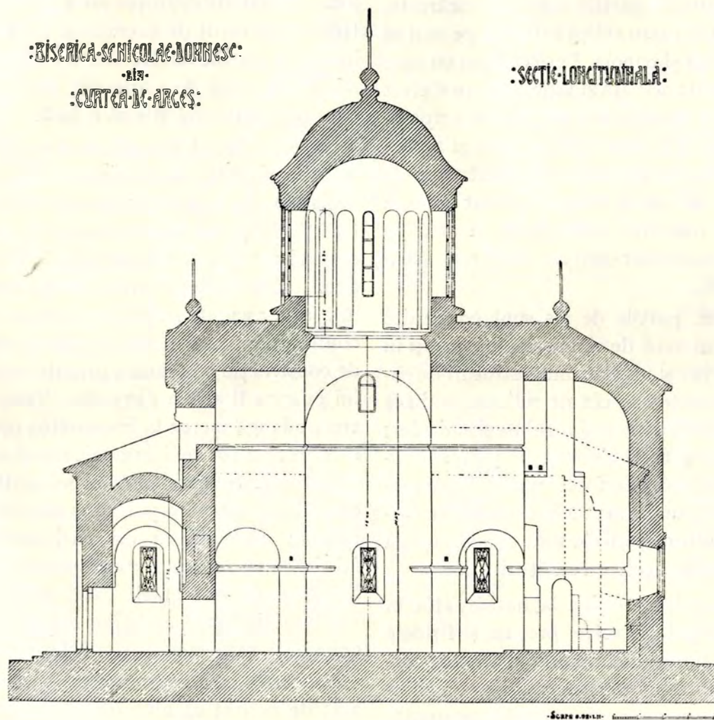
Fig. 119. Biserica Domnească. Secție longitudinală. după restaurare.
