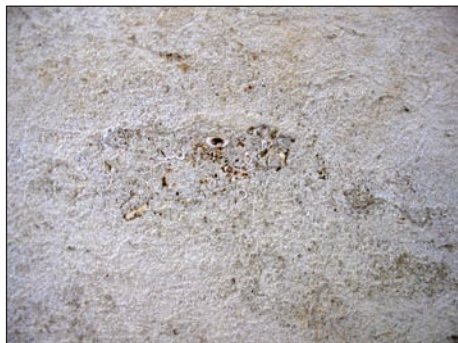
Fig. 2 - Calcar fosilifer, fin granular, cu rare macrofosile (Mf), în nuanțe de alb-cenușiu, rar slab ruginiu. / Fine granular fossiliferous limestone, with rare macrofossile (Mf), in shades of white- gray, rusty rarely weak.
