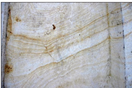
Fig. 6 - Molon de calcar fin granular cu anisotropie compozițională mineralogică, conducând la o structură de tip rubanat. / Block of fine granular limestone with anisotropic mineralogical composition, leading to a structure of rubanaat type.
