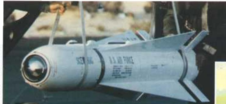
Încărcarea unui proiectil orientat cu laser pe o aeronavă. Detectorul proiectilului captează lumina laser reflectată de țintă.
