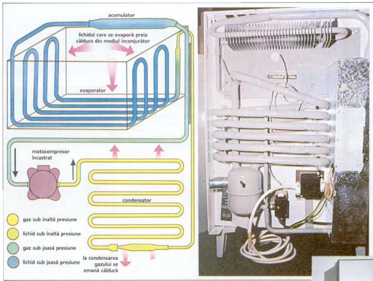
savoarea. Aceasta se face prin coborârea temperaturii incintei congelatorului cu mult sub temperatura de depozitare. Multe modele au unul sau mai multe compartimente separate pentru congelație rapidă, unele cu temperaturi până la -35°C.
