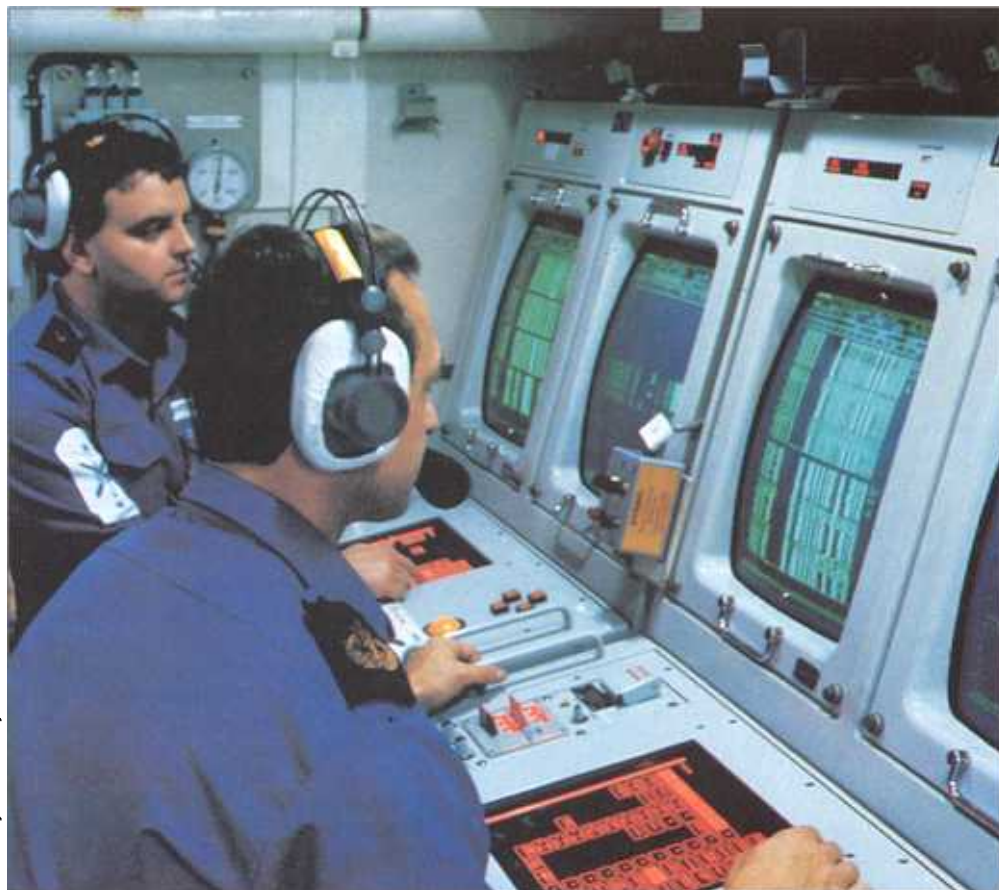
⊕ Echipaj tehnic acționând aparatura sonar și radar la bordul submarinului britanic Trident HMS Vanguard. Aparatura radar poate fi folosită numai când vasul este la suprafață. Sonarul poate fi folosit la suprafață și în timp ce vasul este scufundat.
