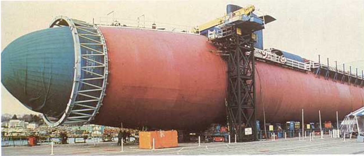
🕒 USS Michigan, un submarin cu propulsie nucleară clasa Ohio, conceput pentru transportul proiectilelor Trident. Submarinul este văzut aici aflat încă construcție pentru Flota Militară SUA.
