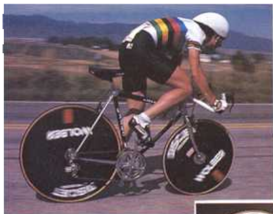
Alergătorii în curse stau aplecați în față pe bicicletele lor și își țin capul aplecat pentru a reduce rezistența vântului, stânga. Roata mică din față, ghidonul curbat și pneurile solide ajută ca vehiculul să fie mai aerodinamic.
