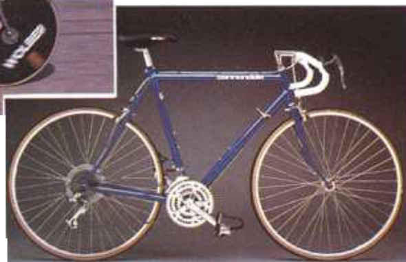
Bicicletele sport, cu cadrele făcute din tuburi de formă aerodinamică din aliaj de oțel sau din aluminiu, păstrează și acum forma generală tradițională, dreaptă.
