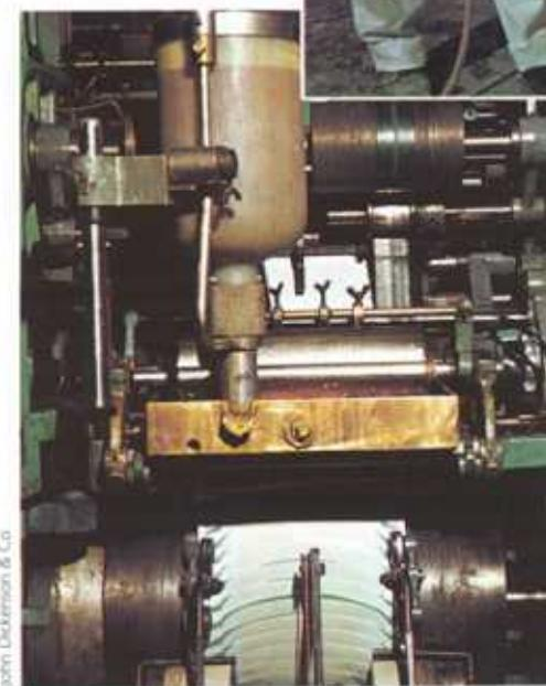
● O mașină folosită la fabricarea plicurilor obișnuite. Se aplică gumă pe îndoitorile plicurilor cu o serie de cilindri. La plicurile cu etanșare automată se folosește adeziv elas-tomer sensibil la presiune.
