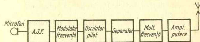
Fig. II.6. Schema-bloc a unui emițător la care modulația de frecvență se obține direct.
