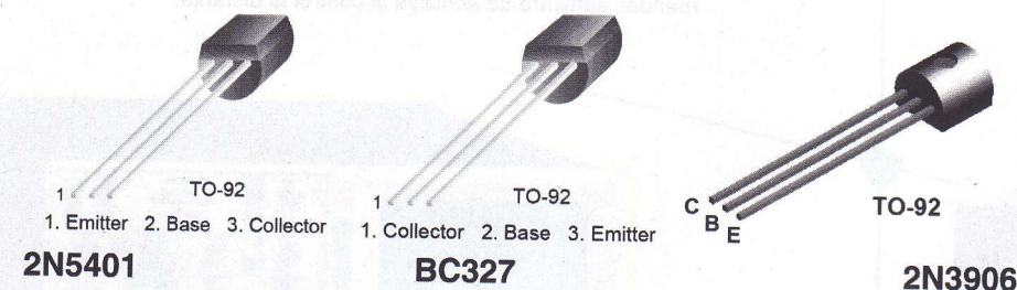
Fig. 3b Tranzistoare recomandate pentru Q2. Atenție la dispunerea terminalelor!
