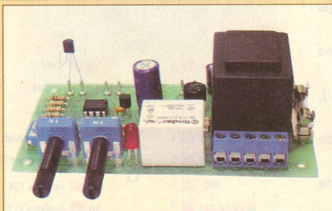
Exemplu de termostat electronic cu histerezis reglabil, realizat de Conex Electronic.
