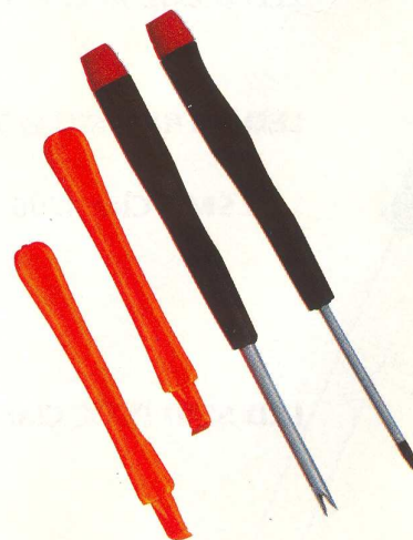
Fig. 1 Instrumente de lucru: șurubelniță torx nr. 6, șurubelniță tip U, spatule
