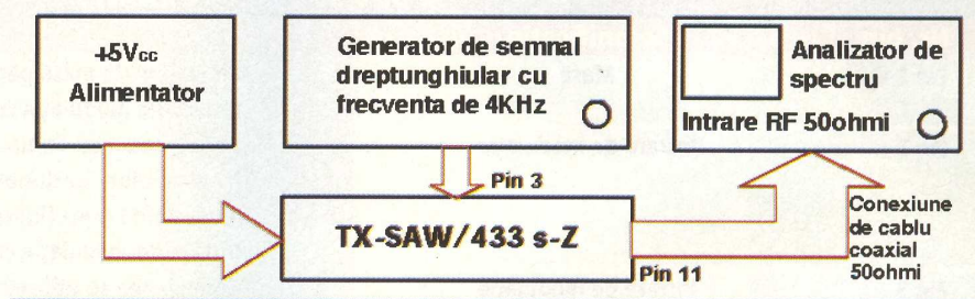
Fig. 1 Schemă de test pentru determinarea parametrilor modulului TX-SAW/433
