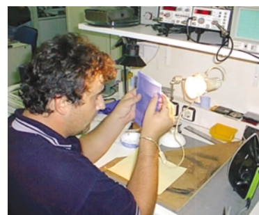
Foto 6 Operația de aliniere a feței "top" de pe folie la fața "bottom" corodată
