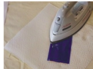
Foto 4 Transferul desenului de pe folie pe laminat
