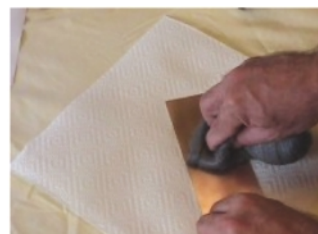
Foto 3 Pregătirea laminatului. Curățarea
