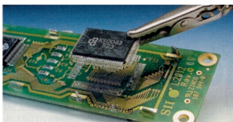
Fig. 2 Îndepărtarea componentei de pe pad-uri
