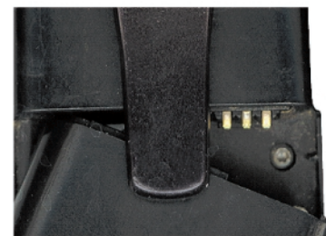
Fig. 6 Conectori de alimentare la modelul T10
