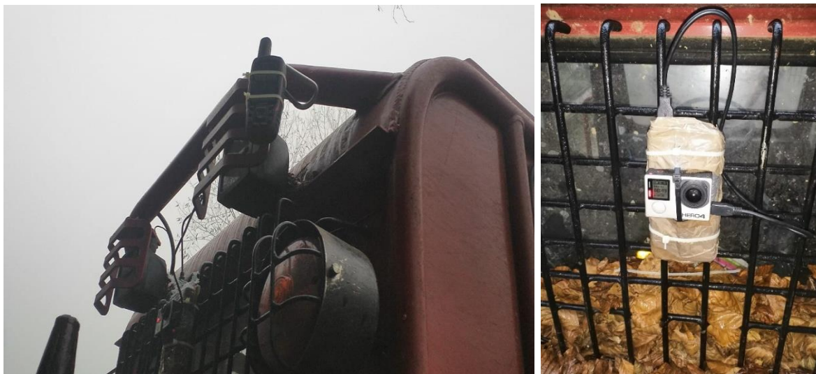
Figura 1. Amplasarea receptorului GPS și montarea camerei (Foto B. Husău și M. Cheța).
