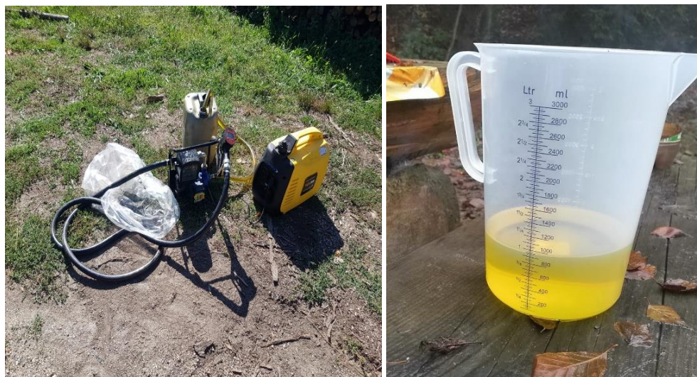
Figura 3. Pompa de alimentare cu combustibil, generatorul electric și vasul gradat (Foto B. Husău și M. Cheța).
