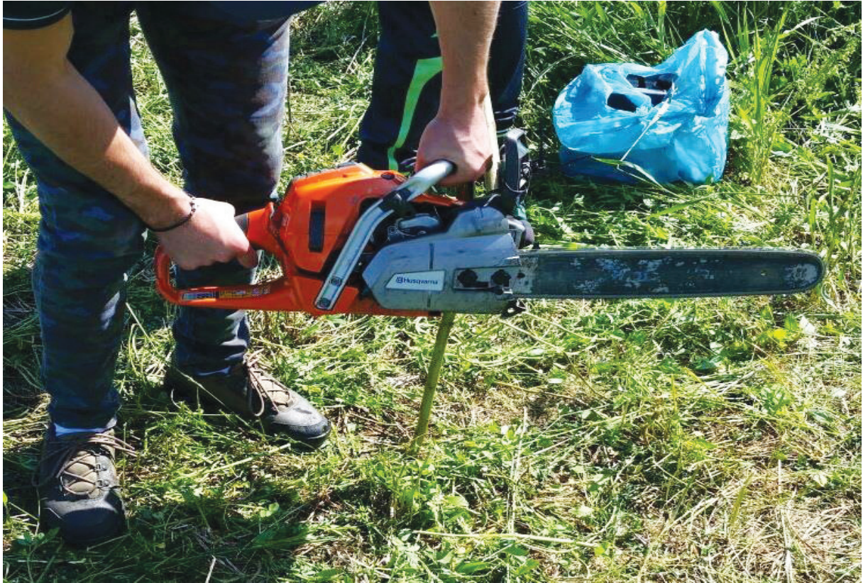
Fig. 4: Poziționarea ferăstrăului pe țărushi în timpul simulării regimurilor de funcționare și a nivelurilor de presiune acustică emise
