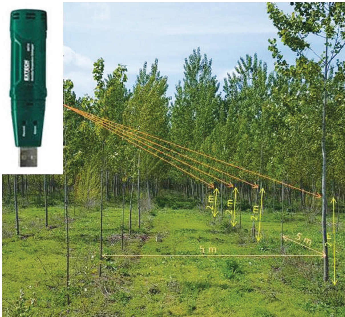
Fig. 3: Modul de amplasare al colectoarelor de date
