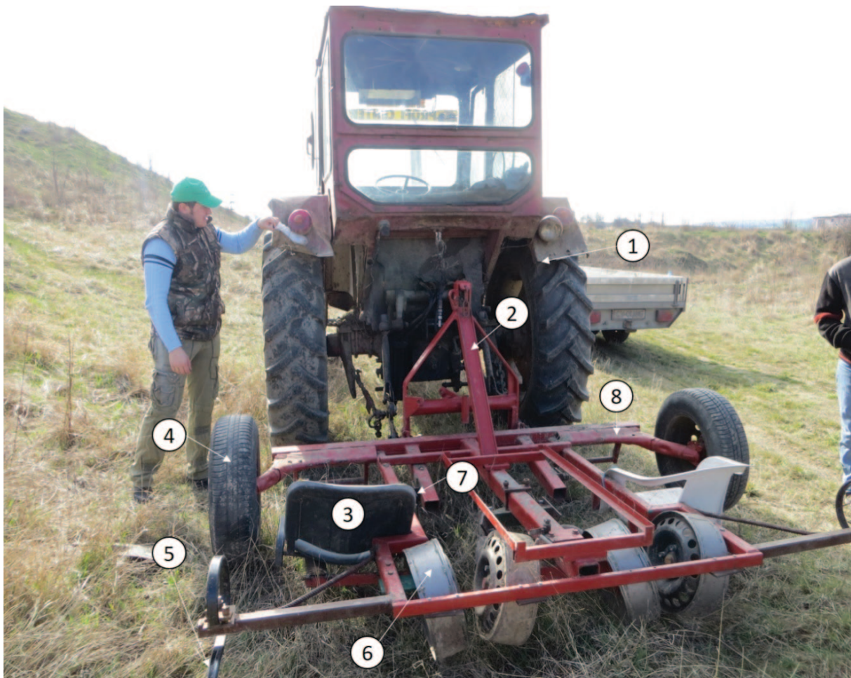
Fig. 5. Alcătuirea agregatului de plantat. Legendă: 1 - tractor, 2 - cuplaj mecanic pentru tracțiune și ridicare-coborâre, 3 - scaun pentru operatorul manual, 4 - roată de susținere a cadrului, 5 - dispozitiv de marcarea a fâșiei de plantat (plantate), 6 - rolă metalică de închidere a șanțului de plantare, 7 - sapă cu rol de dislocator, 8 - cadrul metalic al dispozitivului de plantat.
