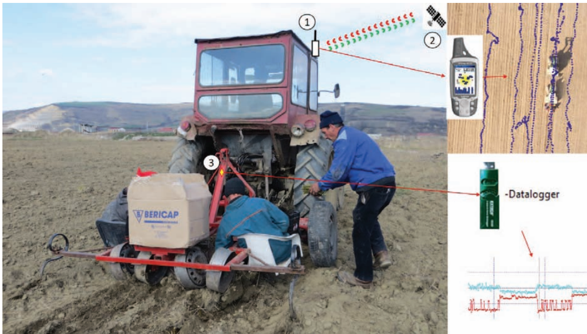
Fig. 7. Concept de monitorizare a performanței productive în operații de plantare. Legendă: 1 - unitate (receptor) GPS, 2 - constelație de sateliți, 3 - senzor de detectare a mișcării (vibrației).
