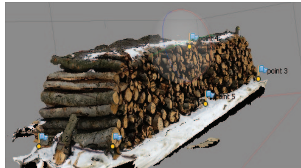
Fig. 13. Distribuția pe stiva de lemn a reperilor fotogrammetrici folosiți la aducerea la scară a modelului 3D
