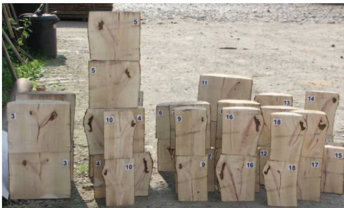
Fig. 4. Eșantioanele despicate pentru măsurarea unghiurilor și lungimilor cioturilor de noduri acoperite
