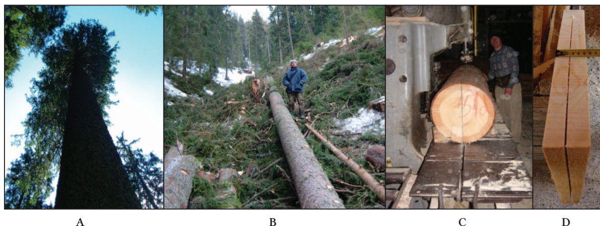
Fig. 2. Lemnul de rezonanță pe traiectoria valorificării: A. arbore de molid de rezonanță pe picior; B. catarg de molid de rezonanță; C. operație la debitarea bușteanului (spintecarea cu ferăstrăul panglică); D. semifabricat de vioară
