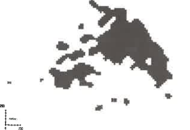
Fig. 5. „Netezire” cu funcția „Majority” a hărții raster pe 1 bit.
