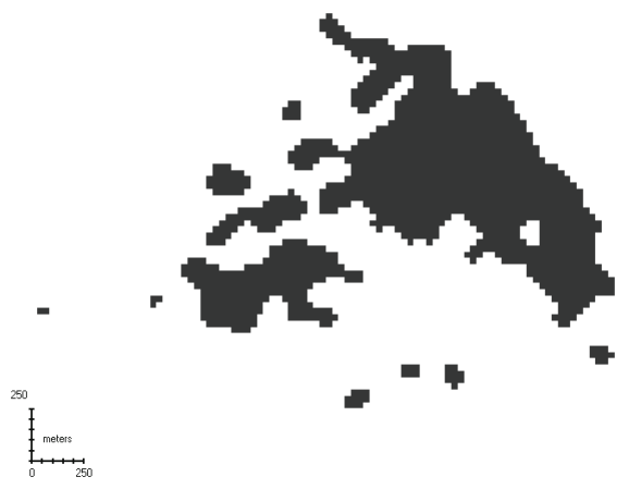
Fig. 5. „Netezire” cu funcția „Majority” a hărții raster pe 1 bit .
