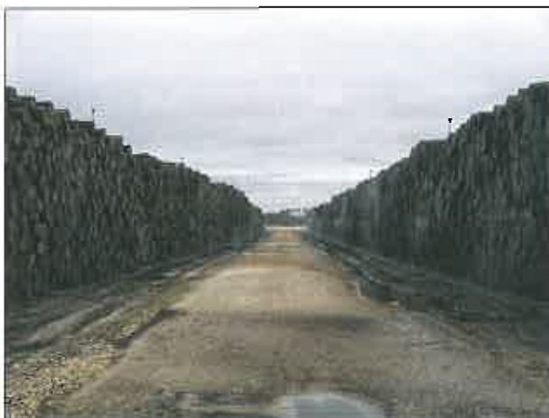
Foto 10. Platformă de conservare prin aspersiune a lemnului (suprafață 30 ha, investiție de 2 milioane euro, din care 80% subvenție de stat, 300.000 m 3 lemn conservat, în valoare de cca. 12 milioane euro) (CAFSA, Commensaq). (foto: V. N. Nicolescu)
