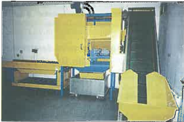
Fig. 1. Instalație pentru curățarea sumară a semințelor
