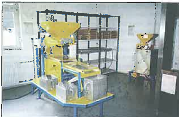
Fig. 2. Mașini pentru sortarea semințelor de rășinoase (molid și larice)
