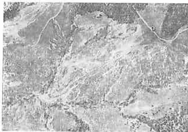
Fig. 3. Suprafețele de teren puternic pluviodenudate fiind lipsite de vegetație apar într-un ton deschis, ce contrastează puternic cu porțiunile de teren neerodate.
