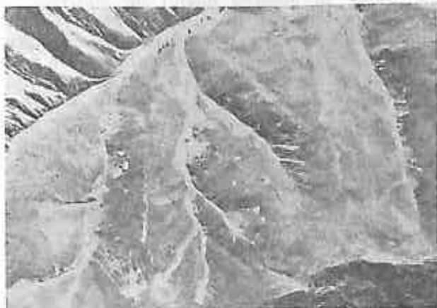
Fig. 6. Ogașele și ravenele fiind bine individualizate apar în ton deschis. Se evidențiază rupturile de mal, precum și forma de labă de gîlscă, ce ia naștere prin dezvoltarea regresivă a acestora.
