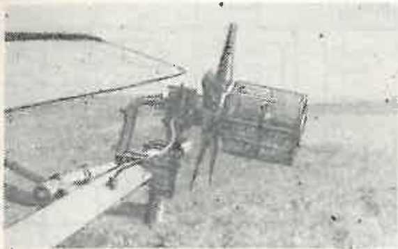
Fig. 2. Pulverizator rotativ Micronair AU 3000.
