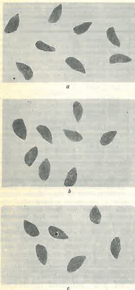
Fig. 1. Seminte din clasa de viteză critică v_{cr} = 5,2 m/s sortate pe baza însușirilor lor electrice (molid, eșantion E_3 )
